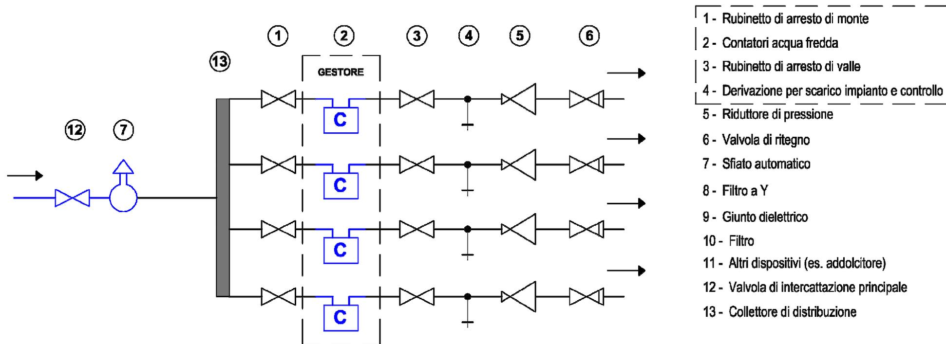
Le parti in colore blu sono installate dal Gestore e restano di sua proprietà. In particolare, i contatori per la misura dei consumi dell'acqua fredda devono obbligatoriamente essere forniti ed installati dal Gestore. I restanti componenti sono invece di norma forniti ed installati da un idraulico abilitato secondo le modalità prescritte dal D.M. n° 37/2008 con oneri a carico dell'utente.
