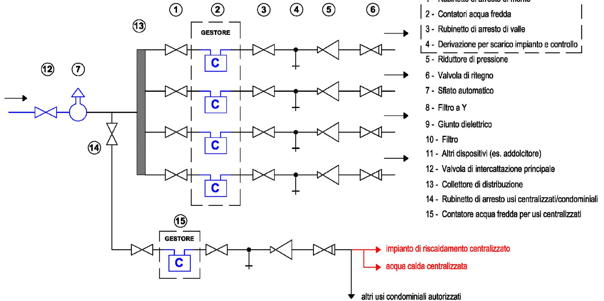
Le parti in colore blu sono installate dal Gestore e restano di sua proprietà. In particolare, i contatori per la misura dei consumi dell'acqua fredda devono obbligatoriamente essere forniti ed installati dal Gestore. I restanti componenti sono invece di norma forniti ed installati da un idraulico abilitato secondo le modalità prescritte dal D.M. n° 37/2008 con oneri a carico dell'utente.
